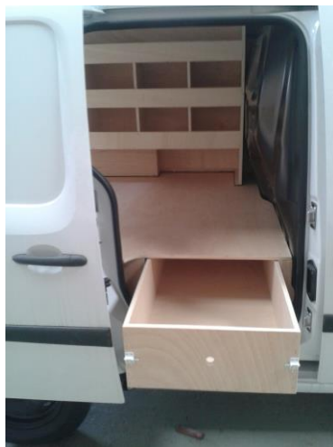
Exemples de double plancher avec tiroir coulissant porte latérale
