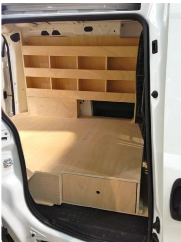
Exemples de double plancher avec tiroir coulissant porte latérale
